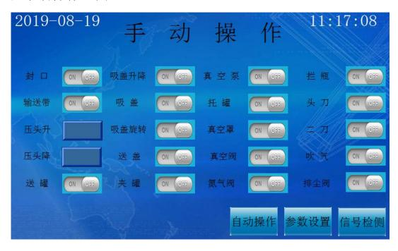
手动操作画面中, 点击各个开关可单独操作各个部件
