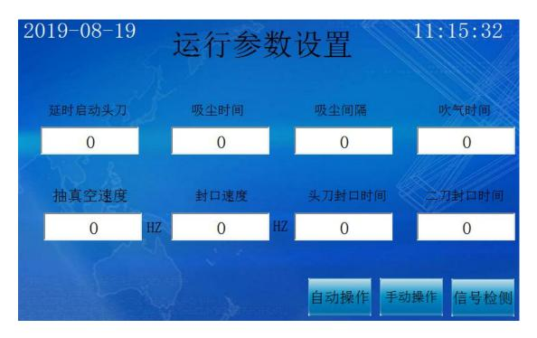
延时启动头刀:设定延时启动头刀的时间(秒)
