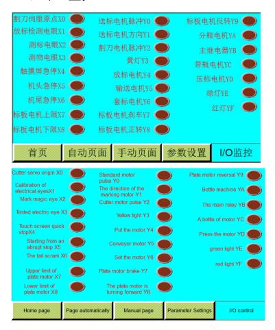
**I/O 监控:** 监控各个功能元件的运转情况,运转的元件涂红表示相应的功能元件在工作,方便用于故障检修。
