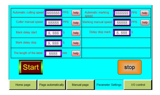
割刀自动速度:割刀电机自动运行的速度。
